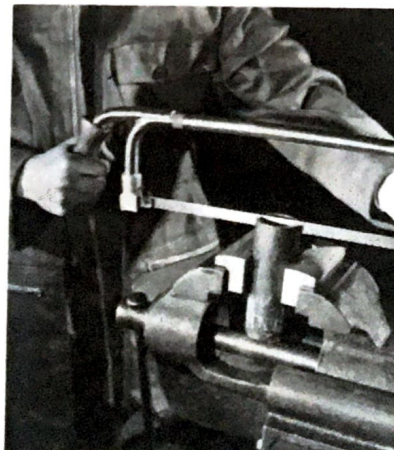
3. Corte longitudinal de caños.
