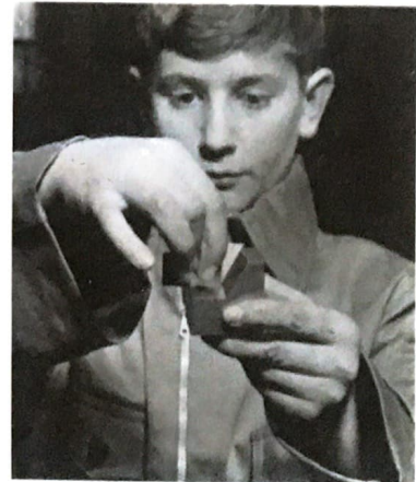
5. Control con calibre fijo.
