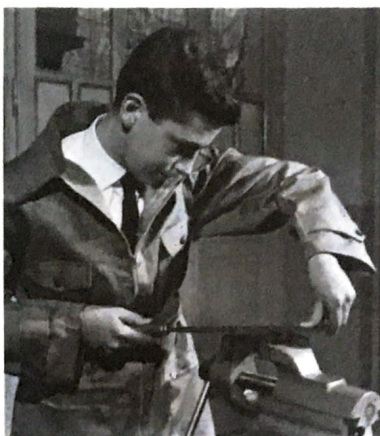
2. Toma de la lima para el acabado.
