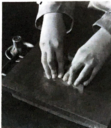
6. Control sobre el mármol.
