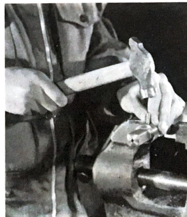
7. Montaje final del pasador.
