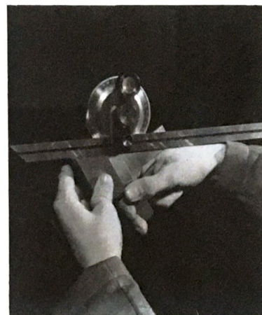
4. Control con goniómetro.
