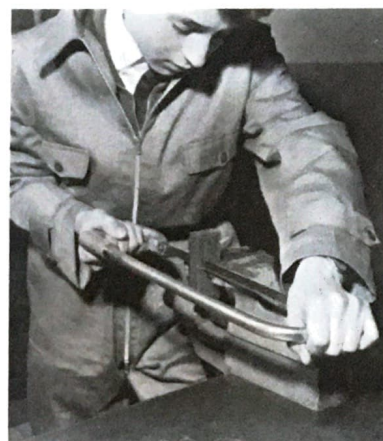
3. Posición para cortes profundos.
