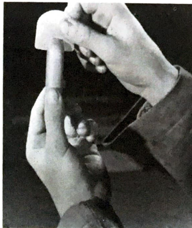
3. Control con calibre fijo.
