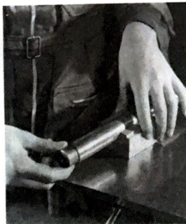
6. Control parcial con cilindro.
