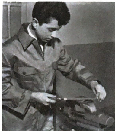
5. Acabado con limas triangulares.
