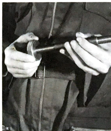
6. Control con anillo roscado.
